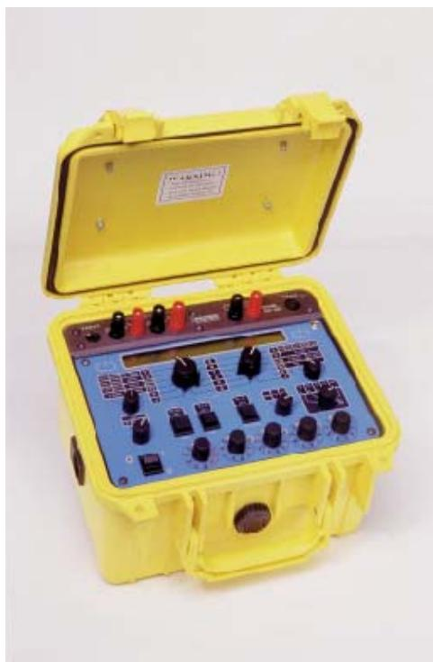
PIC 500 Process Calibrator v sobě slučuje obecné funkce měření i simulace napětí v rozsahu voltů, milivoltů, proudu v miliampérech, odporu v ohmech, kalibrace termočlánků (TČ) a odporových teploměrů (OT), například Pt100 apod. Přístroj je řízen mikroprocesorem a je vestavěn do nárazuvzdorného kufru určeného pro práci v terénu. Současné zobrazení vstupních a výstupních funkcí, ovládání běžnými přepínači umožňuje snadné a přesné ovládání.
